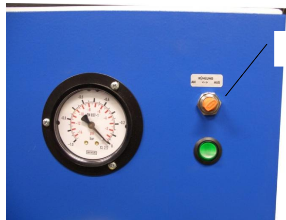
switch „Cooling“, ON <-> OFF (w)
